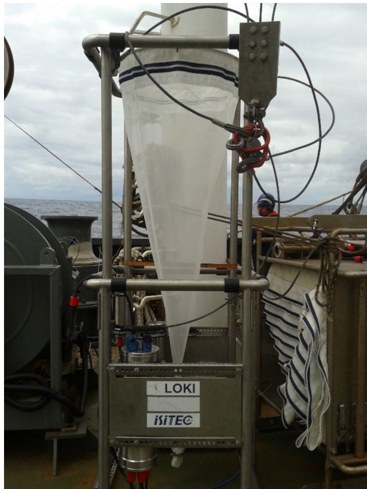
Figura 7: Rede LOKI para coleta e registro fotográfico do zooplâncton.
