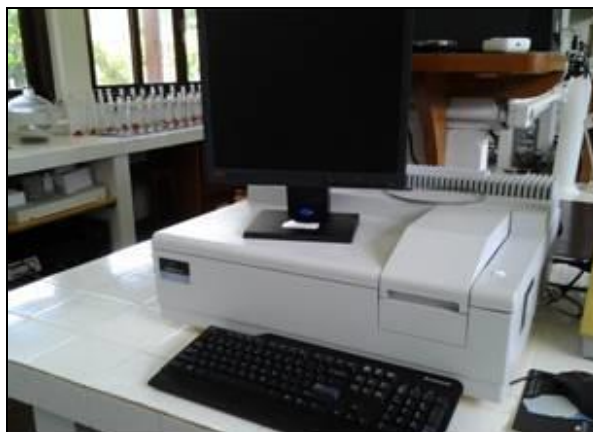
Figura 2 - Espectrofotômetro de UV/Vis. Determinação dos nutrientes (NAT, NO 2 , NO 3 , e PT).
