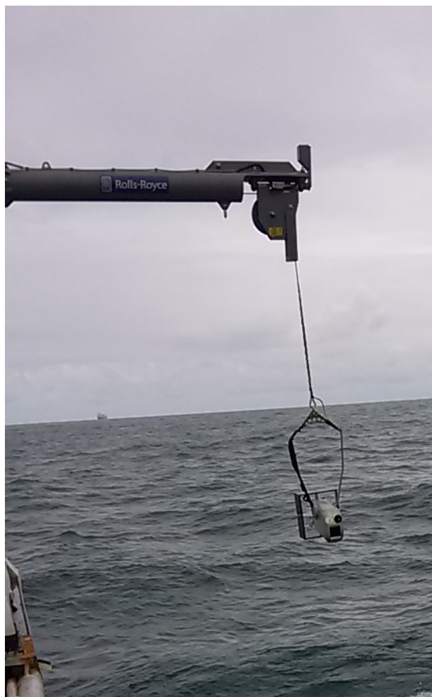
Figura 6: Lançamento do MSFFF do MVP para calibração velocidade do som do Ecobatímetro Multifeixe.
