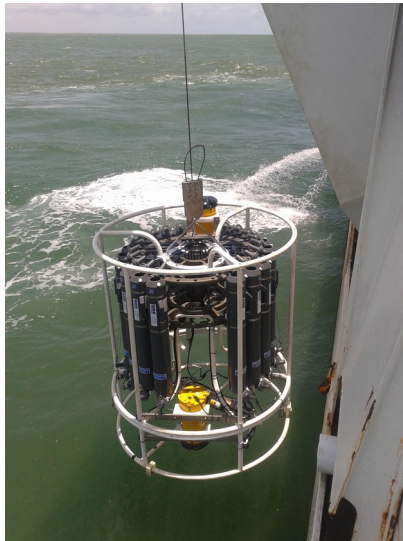
Figura 17: Lançamento conjunto CTD e Rosette.
