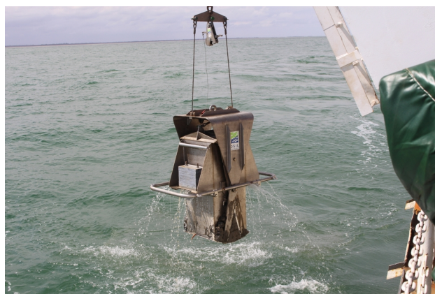
Figura 13: Utilização do Box Corer pelo Navio para coleta de amostras de fundo.
