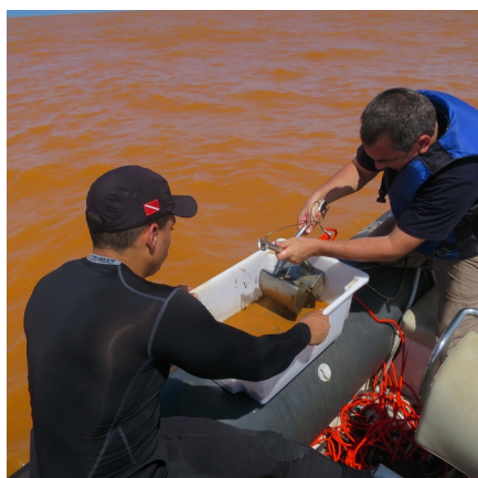
Figura 12: Utilização da draga Van Veen pelo bote para coleta de amostras de fundo.
