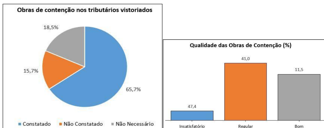
Figura 9: Constatação e qualificação das obras de contenção na área afetada (à direita os percentuais relativos aos 65,7% constatados).
