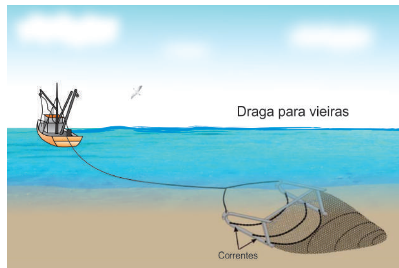
Figura 37 Dragas utilizadas para a pesca de vieiras.
