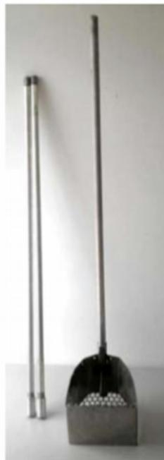
Figura 23 - Concha raspadora para coleta de incrustações do mexilhão-dourado. Fonte: Pereira et al., 2012.
